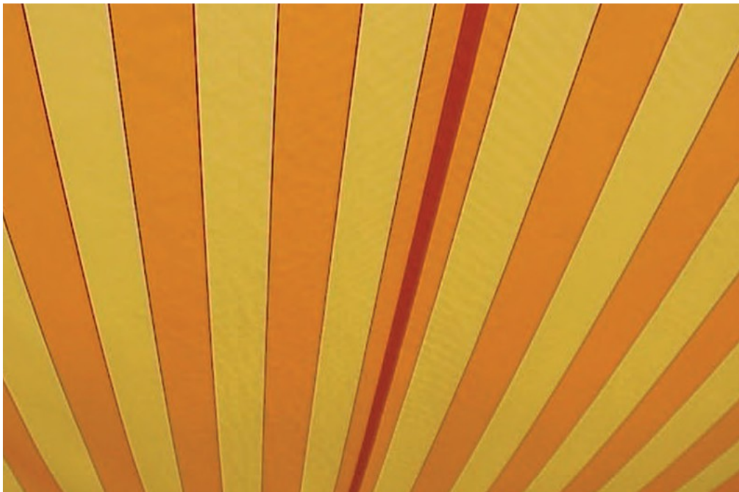
Bild 9.1.8 Tillåten vågighet nära skarven (bikakebildning)
