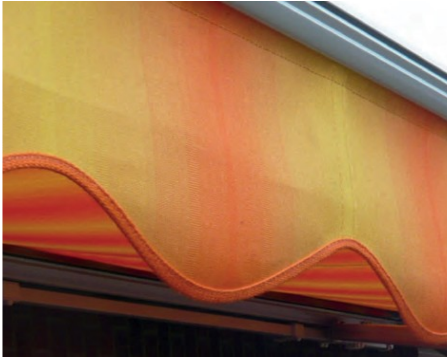
9.1.19 Tillåten förpackningsbetingad veckbildning vid volangen
