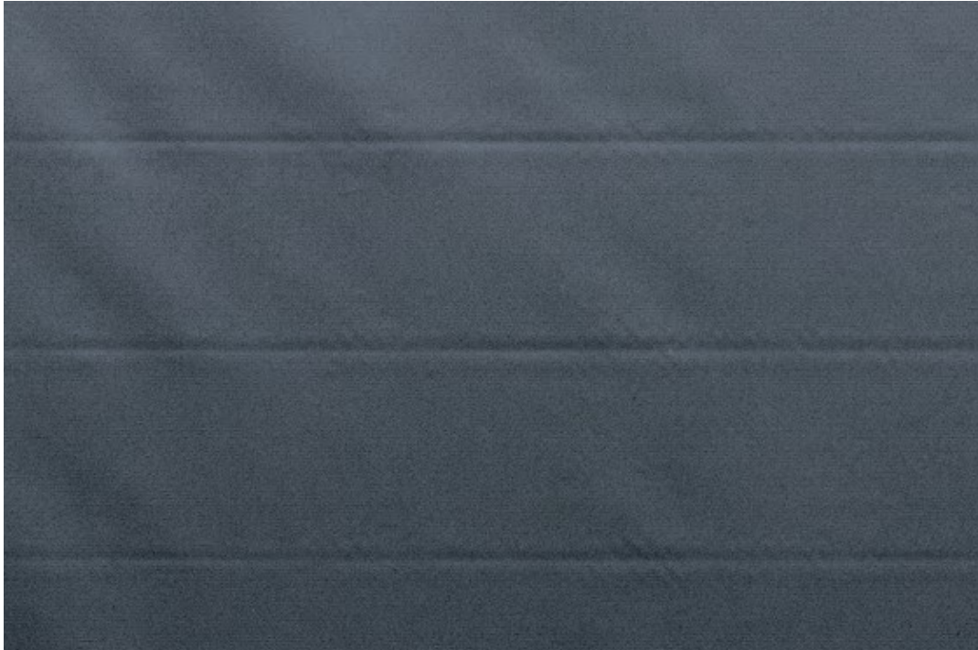
Bild 9.4.3 Möjlig tillåten deformation av dukens yta vid ZIP-system
