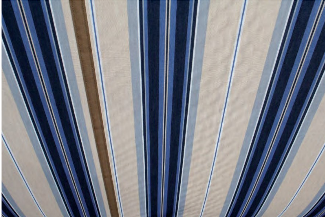
Bild 9.1.10 Tillåten vågighet i banan (bikakebildning)
